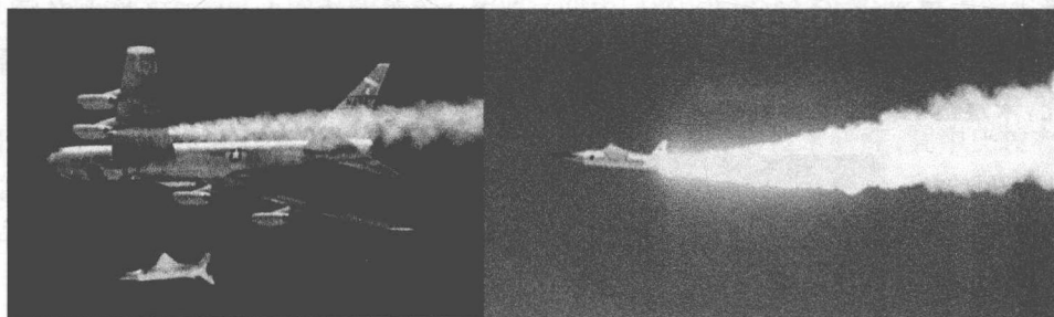
图 1.6 携带 X-43A 的助推火箭与载机 B-52 脱离并点火
