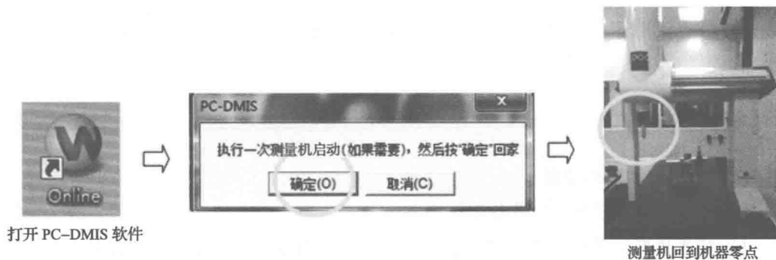
图 2—1—3 开软件、测量机回零点过程
