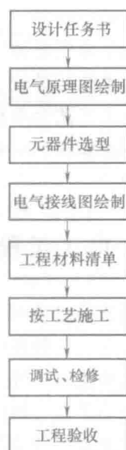
图 1-1 工程制作流程图
