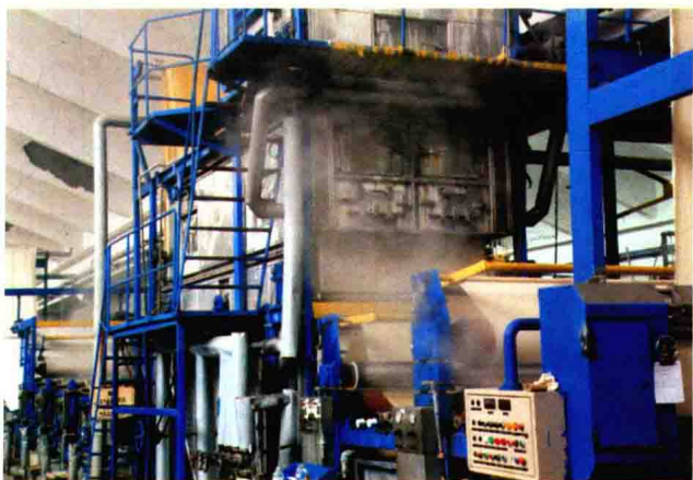
▲ 天津和北京的数十家纺织印染厂将地热水用于洗染流程
