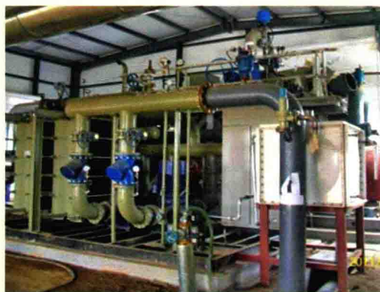
▼ 华北留北油田建成的 400kW 双工质螺杆机地热发电
