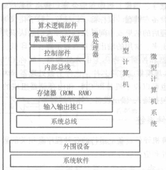
图 1-4 微处理器、微机和微机系统的关系
