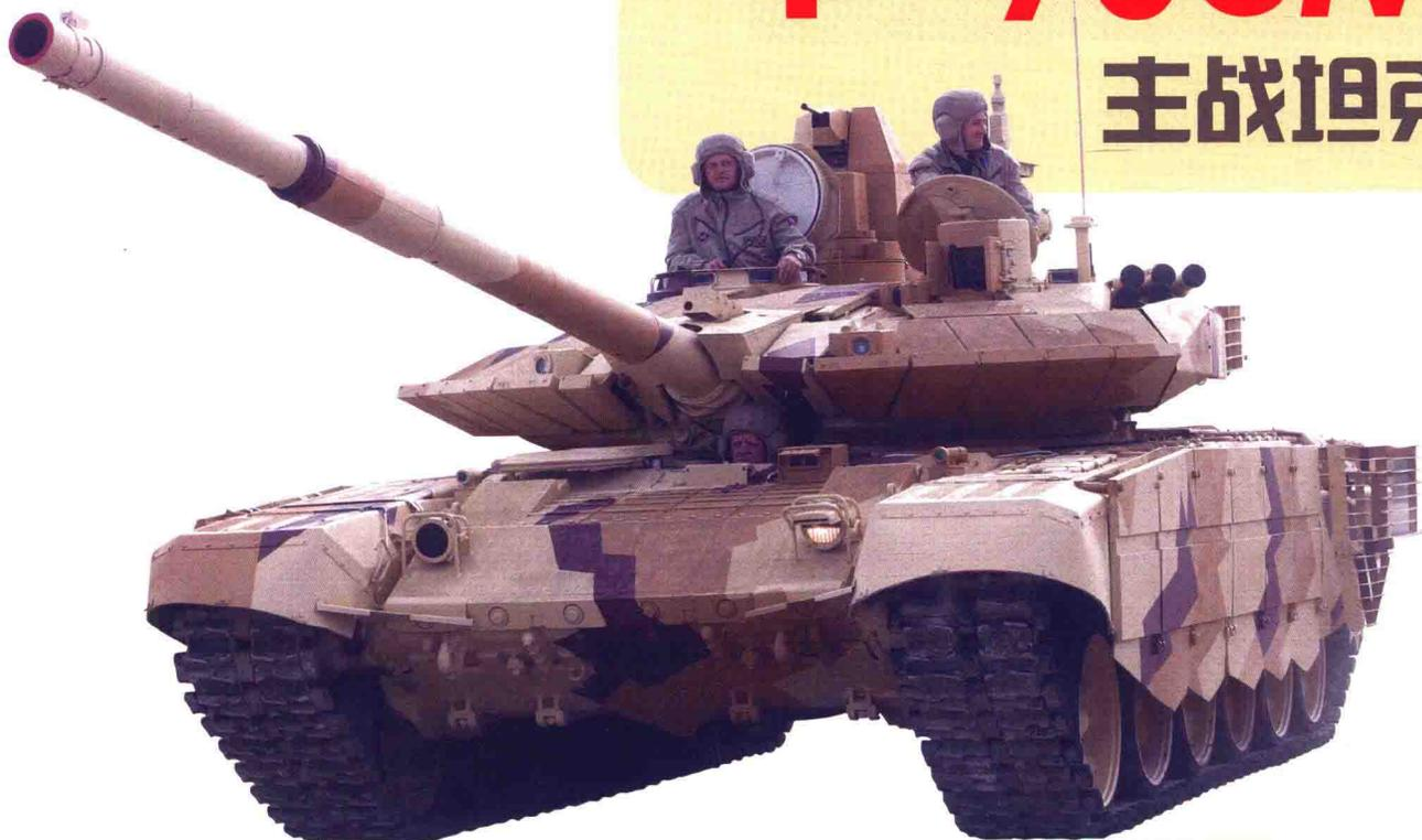
T-90SM是俄罗斯乌拉尔机械车辆厂对T-90的改进升级，号称T-90终极版。它配备了高度自动化的“卡利纳”火控系统和7.62毫米口径的遥控机枪。
