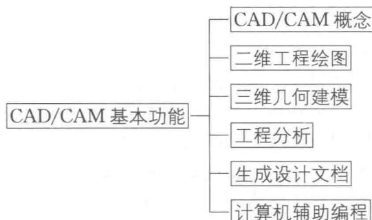
CAD/CAM 是一个人机交互的过程，从产品图形的绘制、几何模型的建立，到 NC 代码生成和加工过程仿真，系统都应保证用户能随时进行观察、修改中间数据。用户的每一
