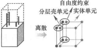
图 2 分层壳-实体混合单元法结构建模示意图
