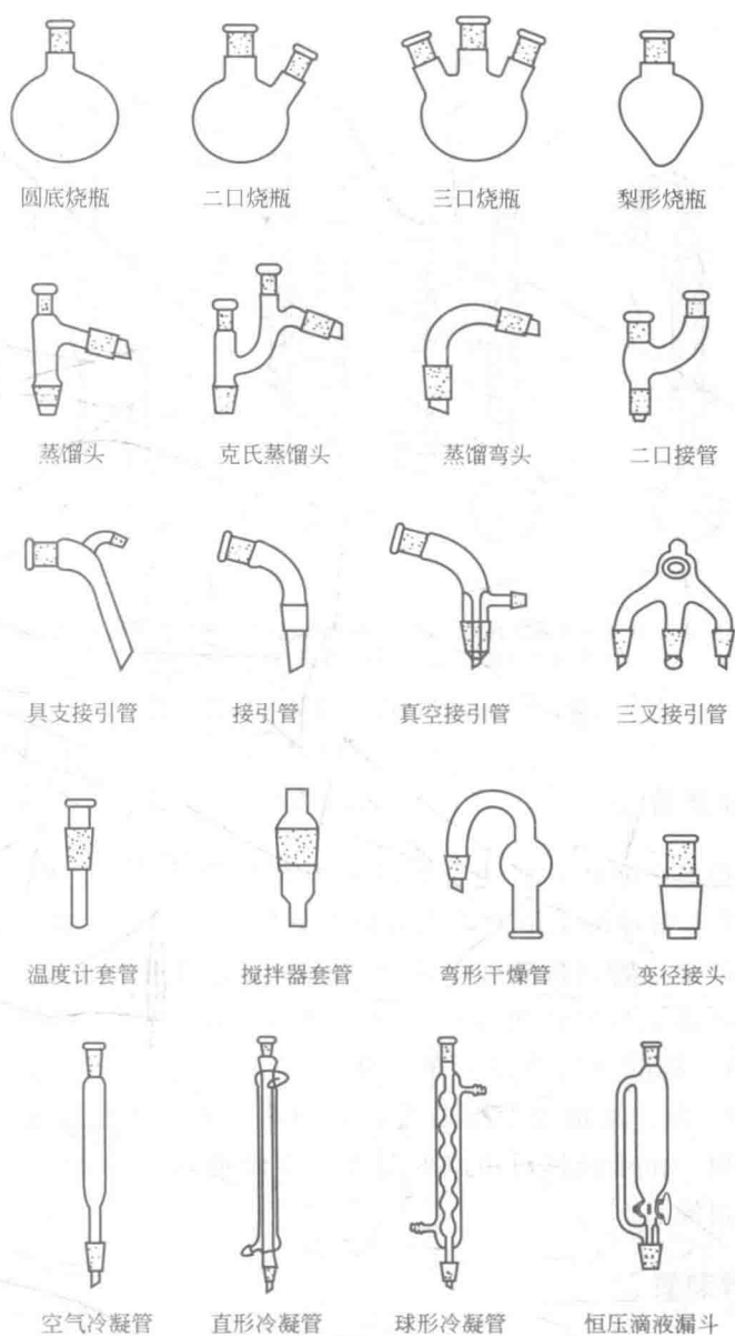
图 1.2 应用化学实验常用的标准接口玻璃仪器
