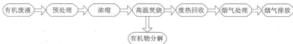
图 1-1 焚烧法处理废液基本工艺流程
