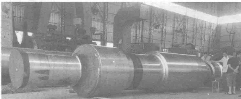
图 1.9 60 万千瓦超超临界汽轮机高中压一体转子
