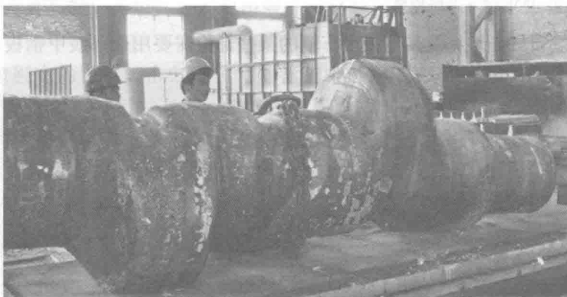
图 1.10 电渣熔铸曲轴毛坯
