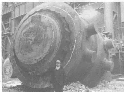
图 1.5 600t 特大型模铸锭
