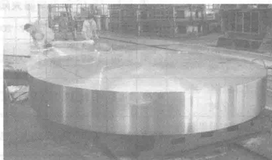
图 1.2 CPR1000 堆芯支承板锻件
