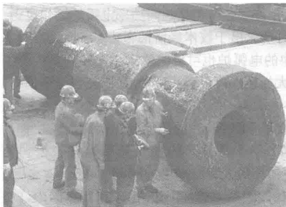
图 1.3 水轮机主轴坯料 ( \phi 1950 \times 6200 )
