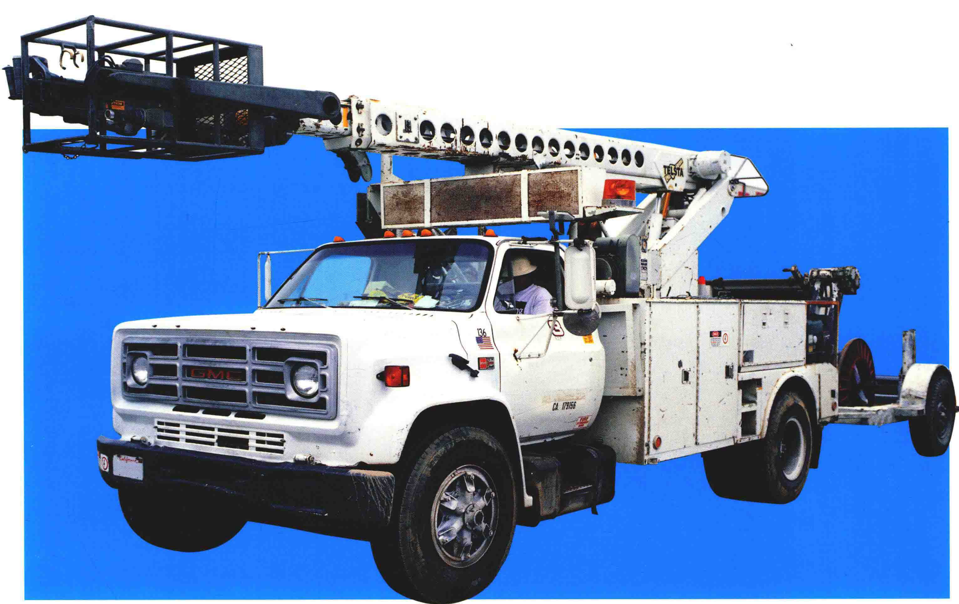
cable repair truck 电缆修理车
