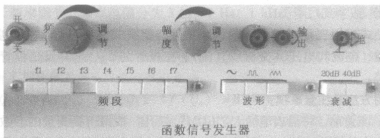
图 1-7 KHM-2 型模拟电路实验台自带函数信号发生器
