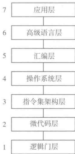
图 P-1 典型计算机系统的层次结构
