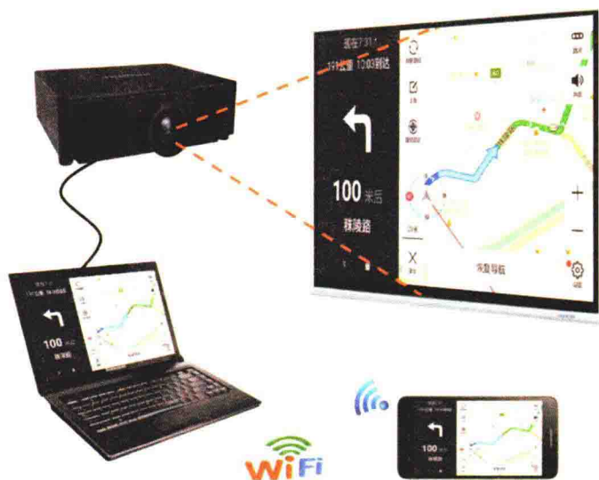
软件方式手机投影的原理
