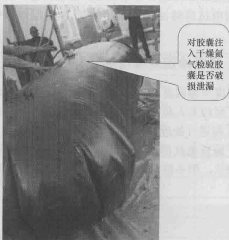
图 1-8 对胶囊充入干燥氮气
