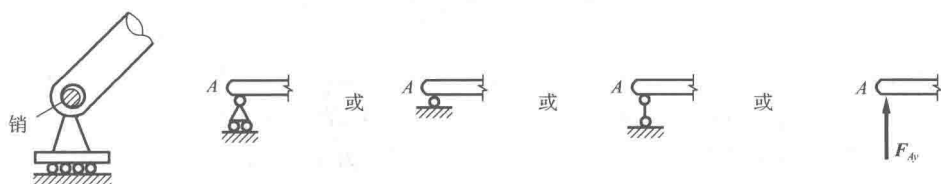
图 1-12 可动铰支座简图及约束力
