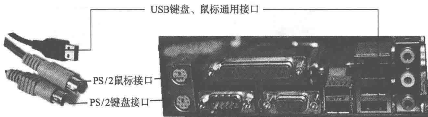
图 1-5 键盘、鼠标的接口及连接
