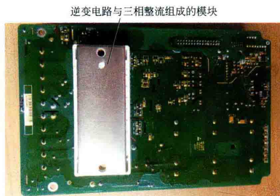
(d) 逆变器与整流模块结构
