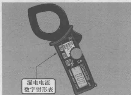
图 1-4 漏电电流数字钳形表的实物外形
