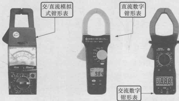
图 1-5 钳形表按照检测的电流分类
