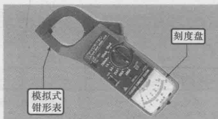
图1-2 模拟式钳形表的实物外形
