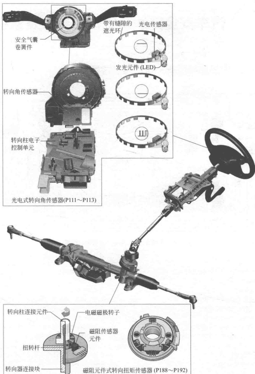
图0-9 转向角度、转矩传感器位置
