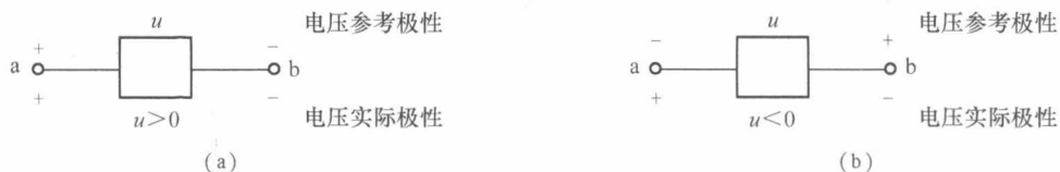
图 1-4 电压的参考极性
