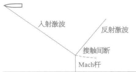
图 1.5 当入射角较大时的激波反射
