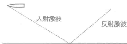
图 1.4 当入射角较小时的激波反射
