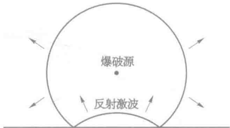
图 1.2 在 t_0 < t < t_1 时的激波反射 (正则反射)
