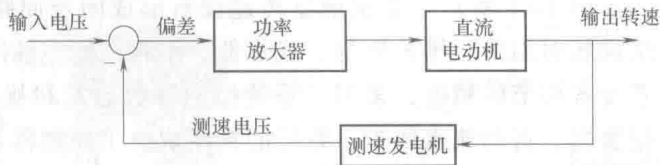
图 1-16 有反馈的电动机拖动系统框图
