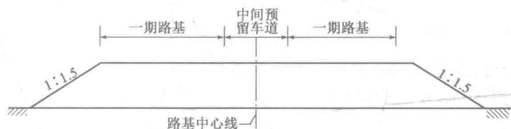
图 1-1 预留中间分隔带加宽方式
