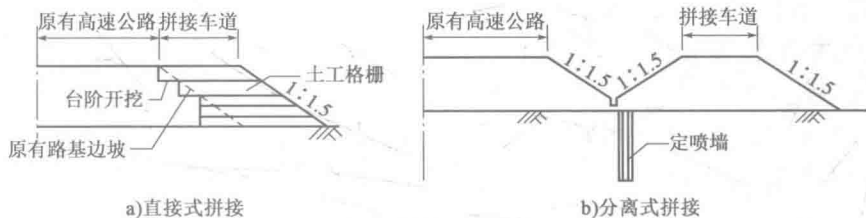
图 1-4 路基拼接方式
