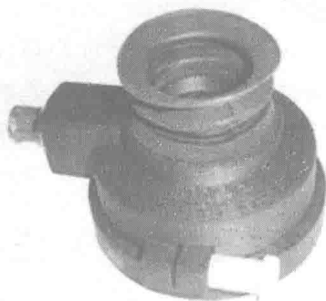
图 1-5 3D 打印的坦克观望机架 (图片来源: stratasys 公司官网)
