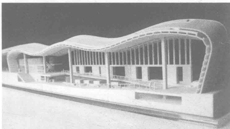
图 1-8 3D 打印的建筑模型 (图片来源: hk3Dprint 公司官网)
