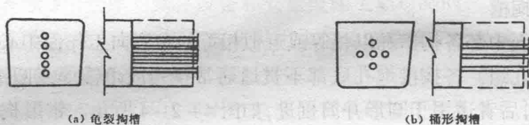
图4-2-5 龟裂与桶形掏槽布孔形式
