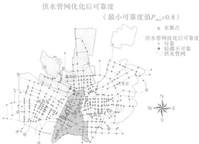
图 1-1 可靠度下沈阳主干供水管网优化图 [19]
