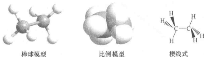
图 1-2 乙烷分子的模型和楔线式
