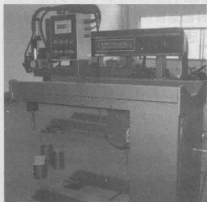
图 1-1 含焊枪摆动器的直缝自动焊机
