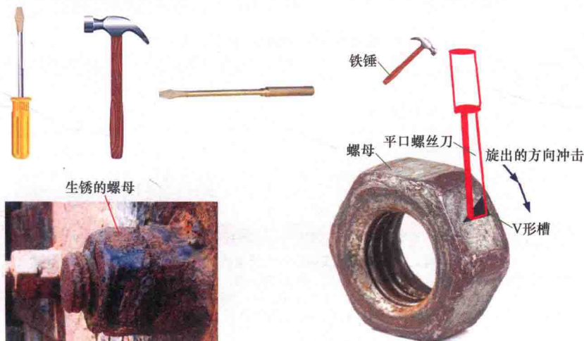
图 1-3 冲击法工具与操作示意
