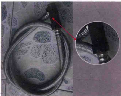
b) 锈死的堵帽与龙头接头图例
