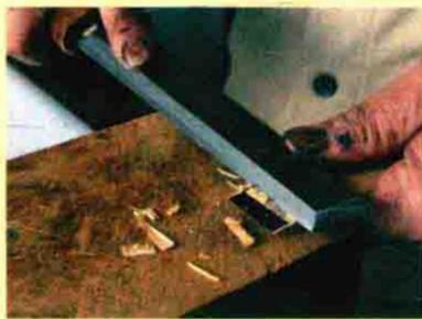
2 削平刷毛部分隆起的棱线，修整刷毛表面至顺滑。另一侧也进行同样步骤，使刷毛尖呈同样形状（如蜡烛火焰的形状）。
