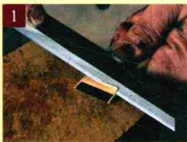
1 用涂师屋刀削掉刷毛根部外侧的木料。调整漆刷的刷毛，至需要的长度。
