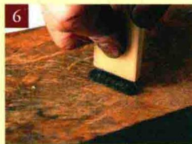
6 将刷毛在台子上压磨，待刷毛全部散开后，用锤子轻轻敲打刷毛。
