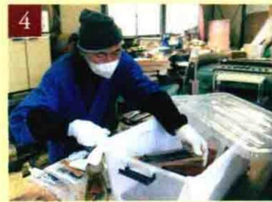
4 通过温度湿度计确认塑料容器内的湿度达到70%左右后,将髹涂漆层的作品放在板子上,随后放入荫房(塑料整理箱)并将盖子严实盖好。
