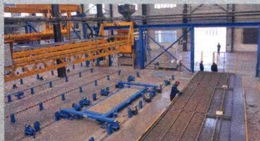
图 C-08 沈阳万融公司引进的生产 PC 构件的德国艾巴维自动化生产线 —— 全国最早一批引进的欧洲自动化生产线
