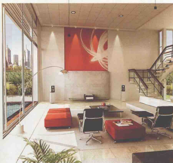
20mm×30mm木龙骨造型硝基漆饰面 — 烤漆玻璃 — 压花玻璃 — 白桦木饰面板
