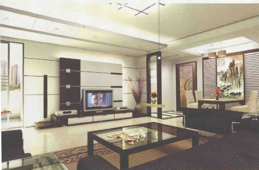
20mm×30mm木龙骨造型硝基漆饰面 — 烤漆玻璃 — 压花玻璃 — 白桦木饰面板
