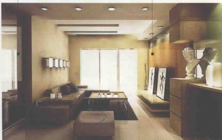
20mm×30mm木龙骨造型硝基漆饰面 — 烤漆玻璃 — 压花玻璃 — 白桦木饰面板
