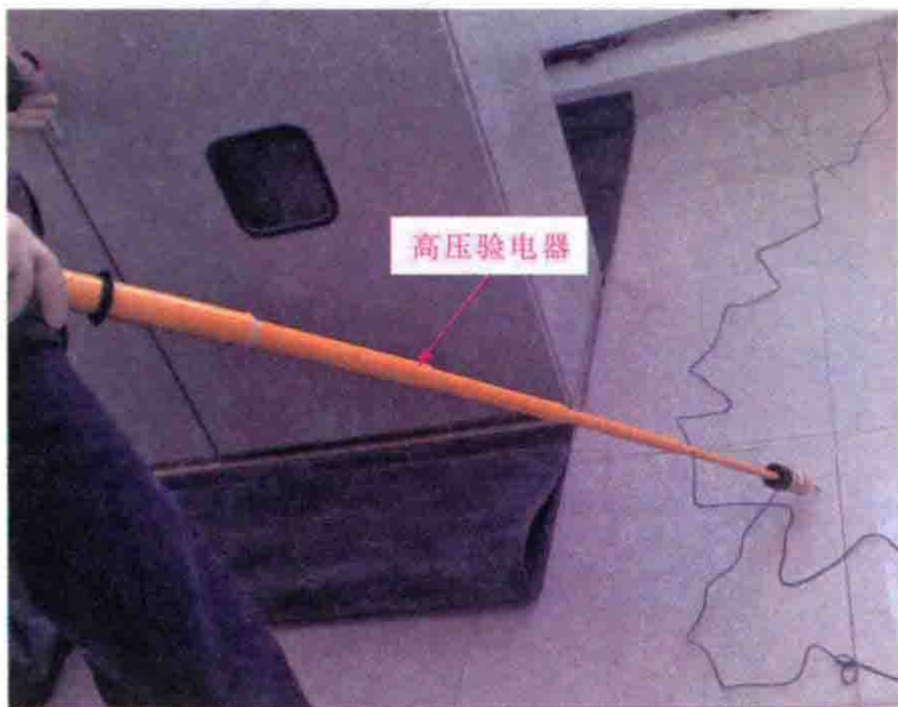
图 1-14 高压验电器使用前检测自身性能
