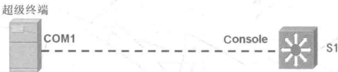
图 1-7 交换机的密码恢复和 IOS 恢复实验拓扑
