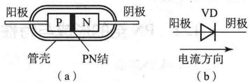
图 1.6 二极管的结构和符号 (a) 结构示意图; (b) 电路符号
