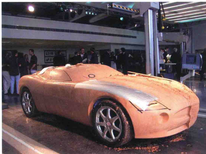
彩图 1 制作 1 : 1 外部油泥模型(接近成形)
