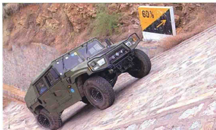
彩图 3 东风猛士军用越野车在进行爬坡试验(坡度 60%)
