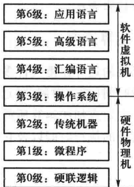
图 1.3 计算机系统的分层虚拟结构
