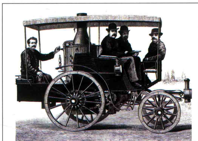
1884年法国德迪恩-布顿（De Dion-Bouton）公司制造的“面对面”式蒸汽汽车，车尾那位是负责蒸汽锅炉操作的“司炉”
