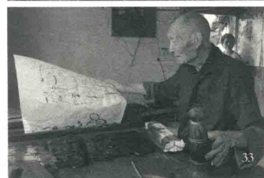
图 28：印刷年画工艺流程第一步：放置并固定好雕版。图为佛山年画艺术家冯炳棠在固定雕版
