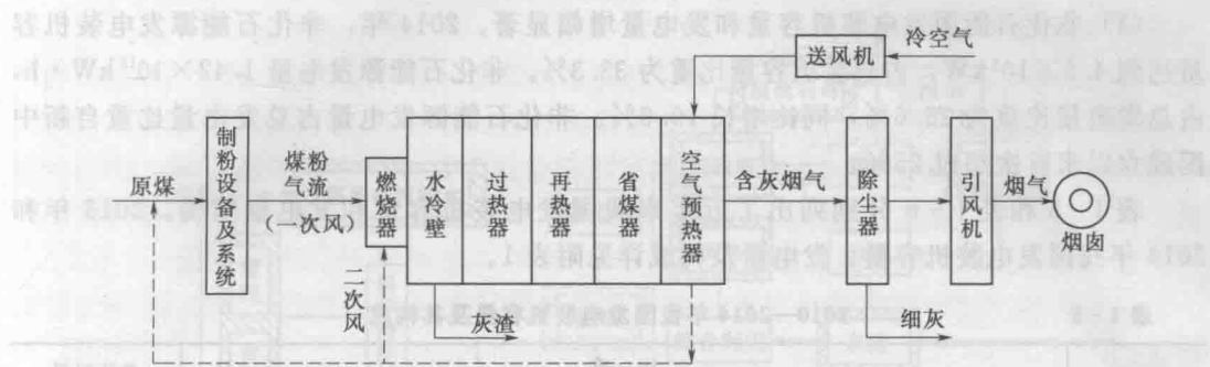
图 1-3 煤-烟气系统工作流程示意图
