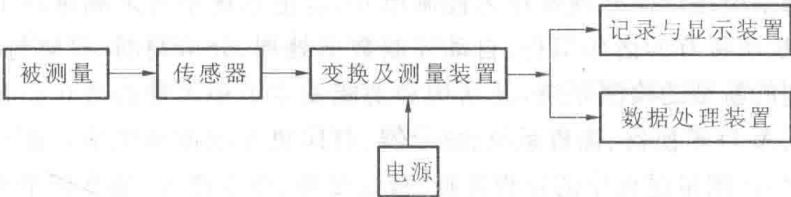
图 1-1 汽车检测系统的基本组成图
