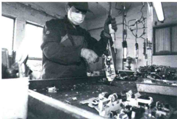
图1-7 生产线上弹性悬挂的螺钉旋具（螺丝刀）
