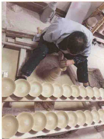
图 1-2 辘轳车上手工拉坯 作者拍摄于景德镇皇窑博物馆
