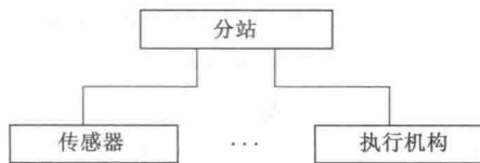
图 1-5 传感器及执行机构采用星形结构与分站连接
