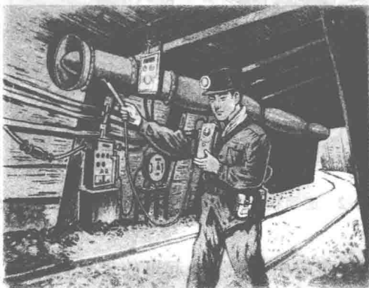
图 1-1 瓦斯爆炸必须在瓦斯浓度、引爆温度和氧气含量达到一定范围时才发生
