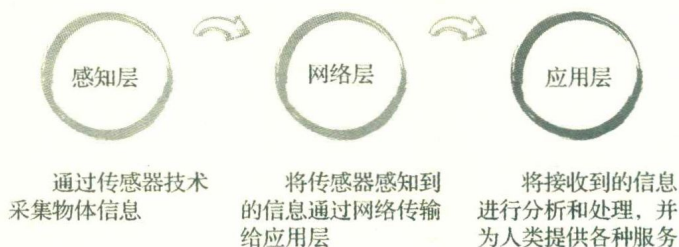
图 1-25 物联网体系结构
