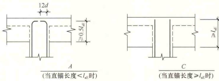
初学者在看平法图集时，缺乏空间理解力，容易按图集字面意思简单理解，比如当直锚长度小于  $l_{aE}$  时，KZ 伸入 WKL 内的长度错误地计算为  $0.5l_{aE} + 12d$ 。
