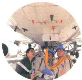
国网江苏电力“陆电登机”系统实现以电代油。
