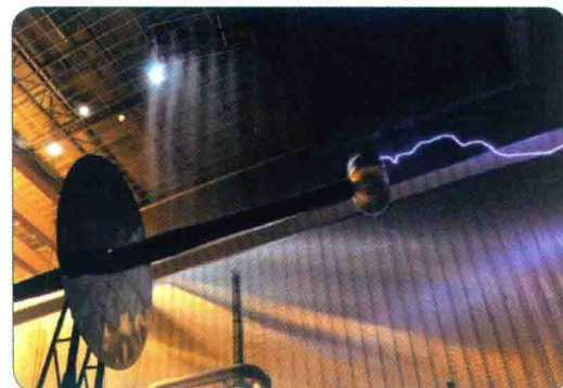
依托准东—皖南±1100kV特高压直流工程，开展直流穿墙套管研制。
